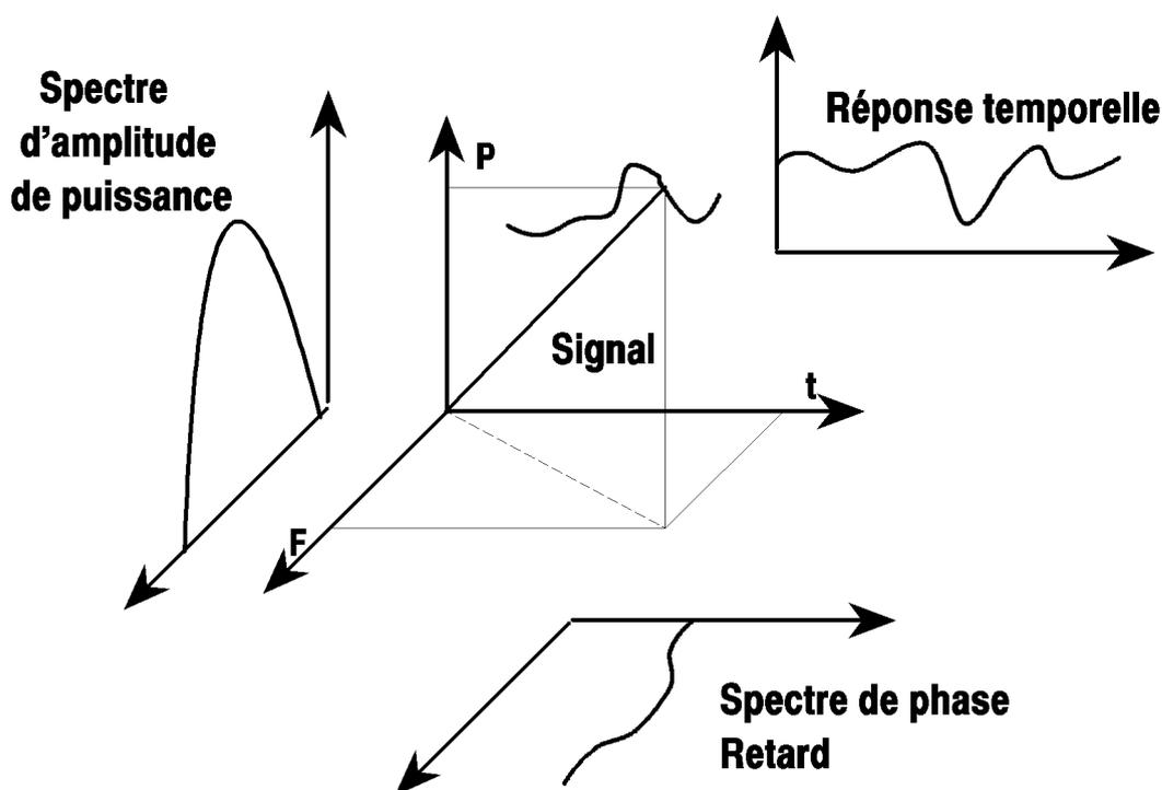
les variations de phase ou de retard d'un signal transmis ou traité en fonction de sa décomposition en fréquence.
