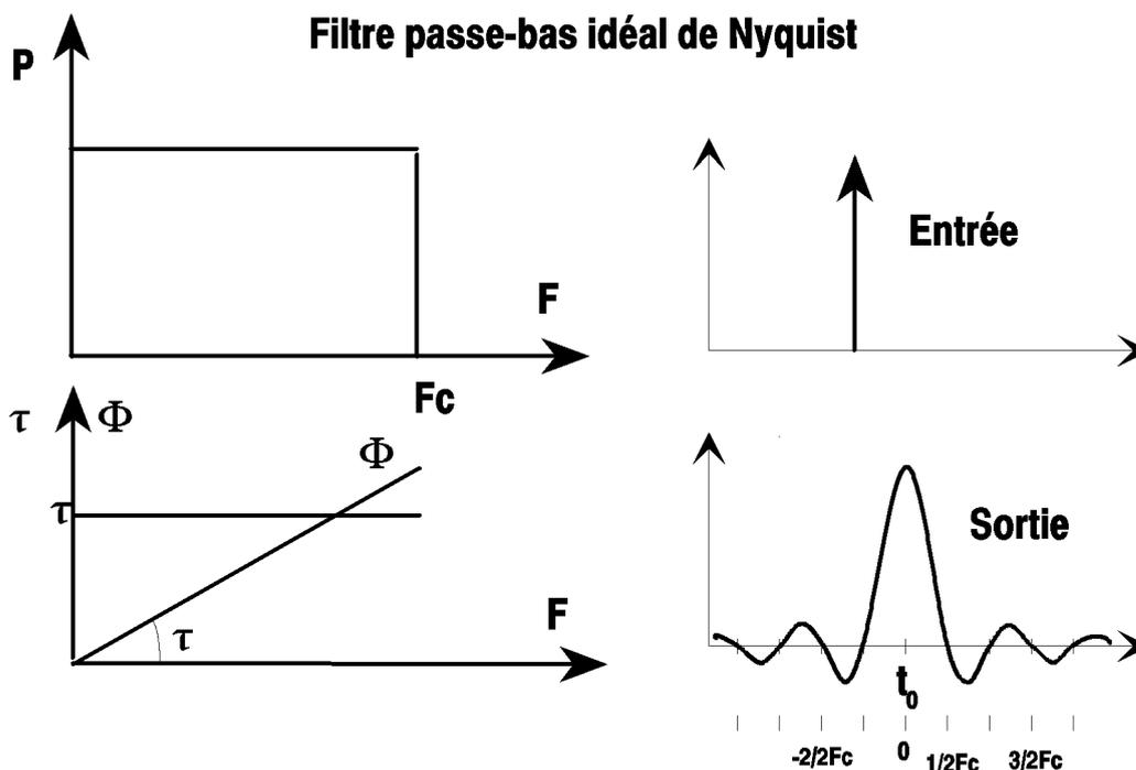
une impulsion de Dirac, de puissance finie, on montre que le signal en sortie prend la forme :
