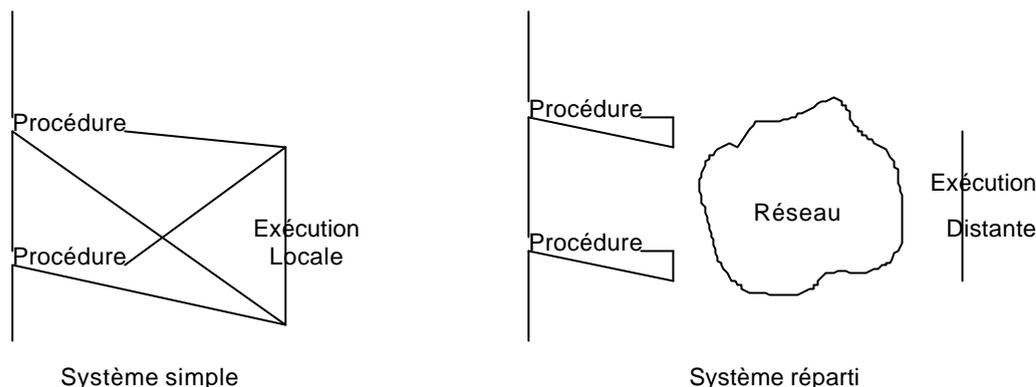
Le programme appelant n'est normalement pas modifié. Sur le système local, des procédures "agents", représentant les procédures distantes qui effectuent réellement les traitements, sont invoquées par le programme appelant. Elles réalisent l'appel réel aux procédures distantes à travers le réseau. Ces procédures réelles sont installées sur un "serveur de procédures".
