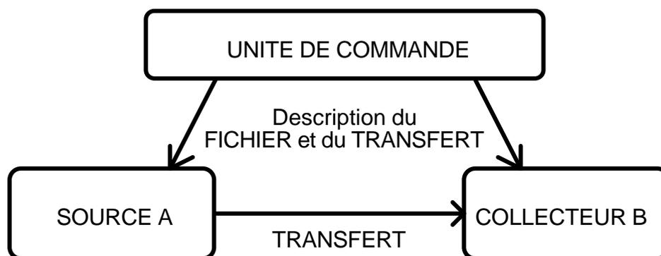
Pour simplifier la coordination et la commande, on suppose que l'unité de commande véhicule ces flux via l'une des deux entités du protocole qui agit comme son agent pour réaliser le transfert. Ceci est illustré sur le schéma ci-dessous :
